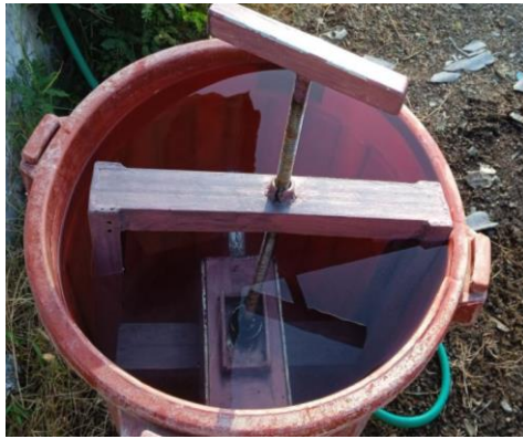
Gambar 4. Posisi perendaman cetakan paving berisi adonan paving
