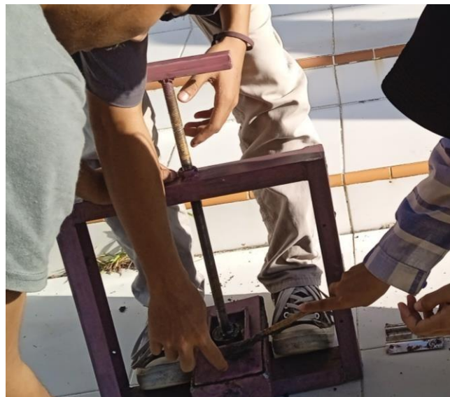
Gambar 2. Posisi cetakan paving setelah semua adonan dituang
