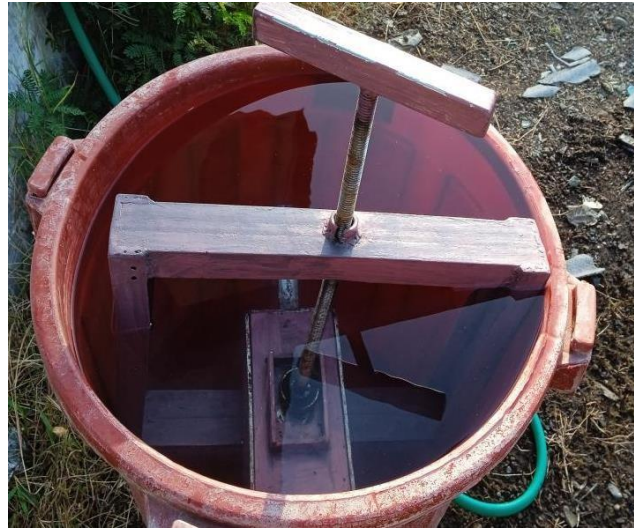
Gambar 3. Posisi perendaman cetakan paving berisi adonan paving
